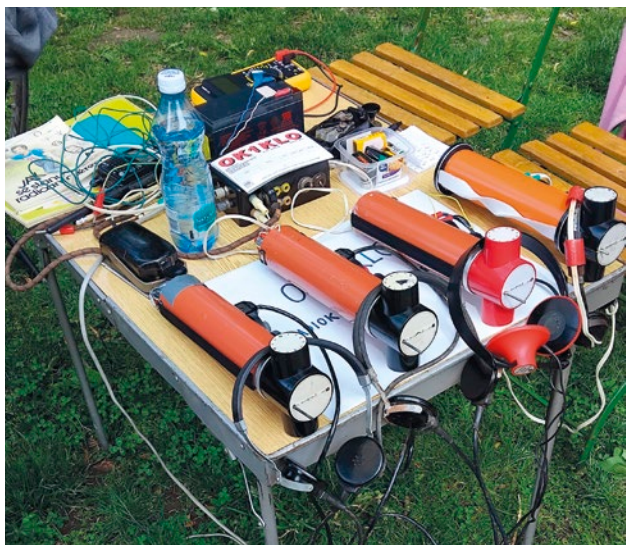
Zepředu: 4 zaměřovací přijímače pro Hon na lišku, uprostřed trenažér Morseovy abecedy s telegrafním kličem, napájený z akumulátoru. Na trenažéru je tzv. QSL lístek našeho radioklubu (ten si radioamatéři posílají jako potvrzení o navázání radiového
